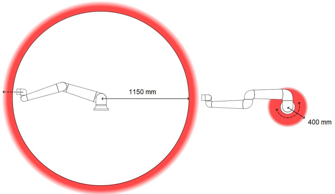
由于机械臂的物理特性, 某些工作区需要注意夹伤危险。其中一个区域(左)是定义的径向运动区域, 即手腕 1 关节与机器人基座至少相距 1150 mm 的区域。切向移动时, 另一个区域(右)距离机器人基座 400 毫米以内。
