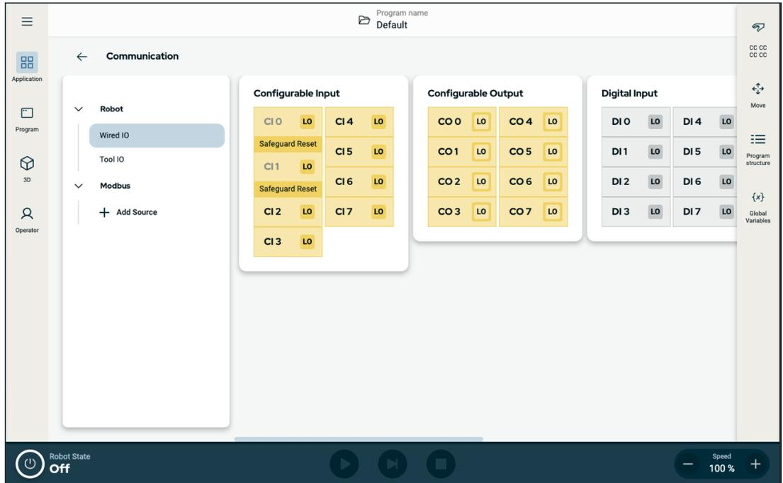
图 1.2: 显示 I/O 的通信屏幕。
