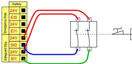
在本例中，门开关是一种基本的防护装置，当门打开时，机器人就会停止。
