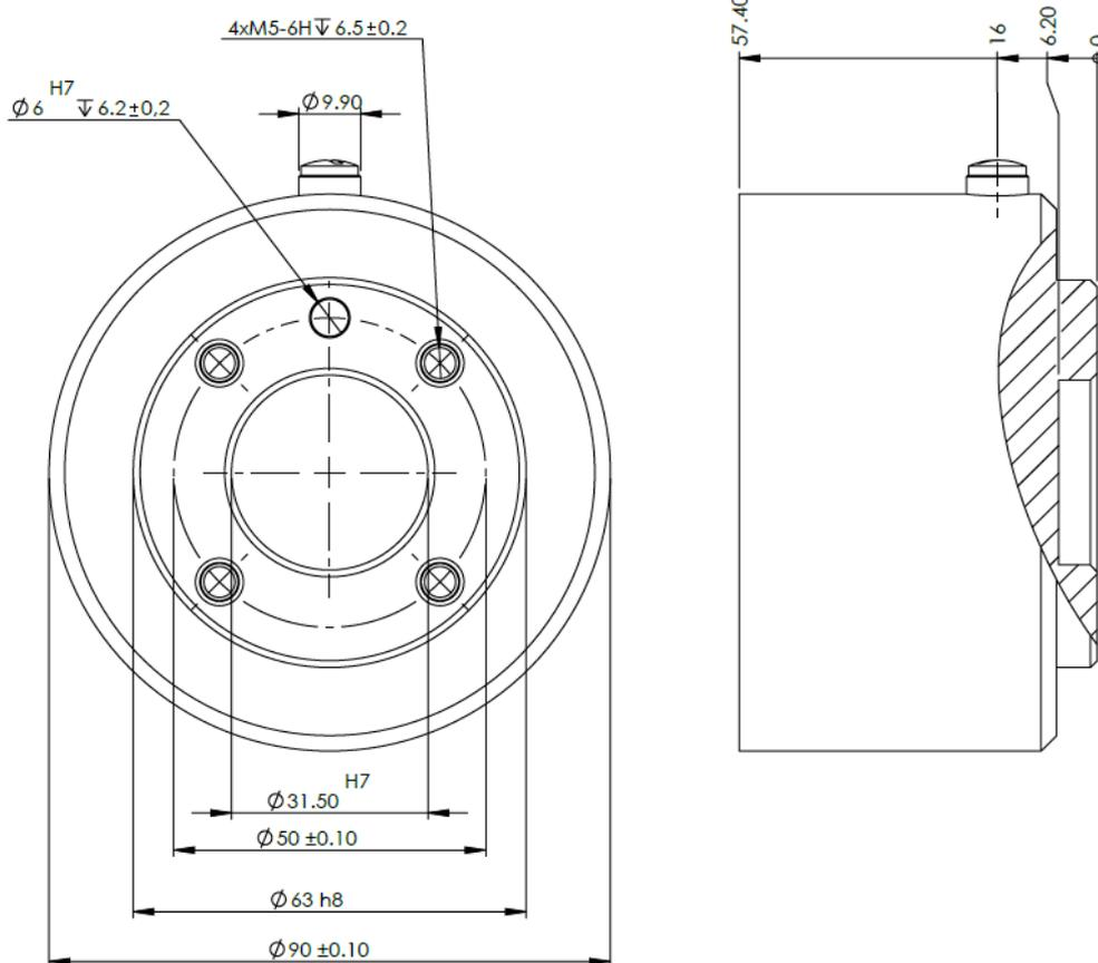
工具法兰的尺寸和孔图案。所有测量值均以毫米为单位。
