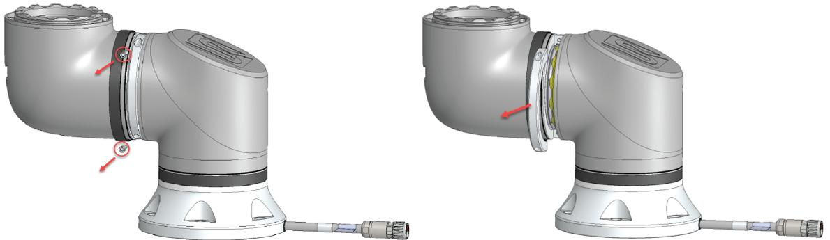
4. 在拆下夹具的另一侧时，支撑关节。
