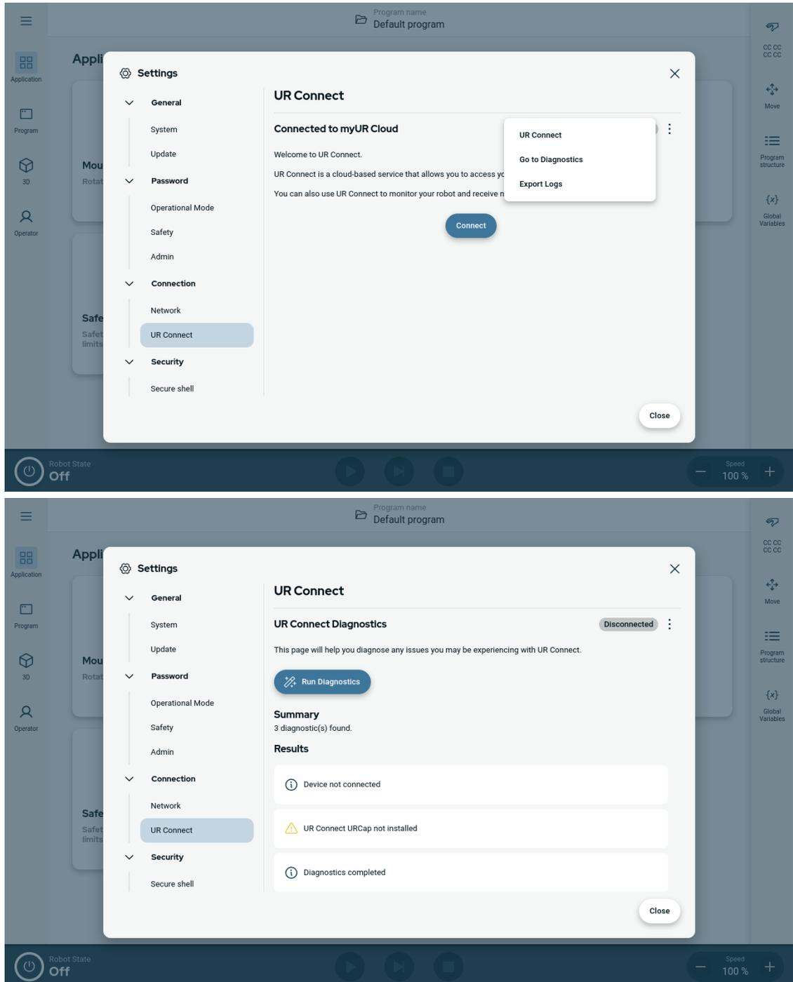
导出日志 可以从 PolyScope X 软件中导出 UR Connect 日志。
