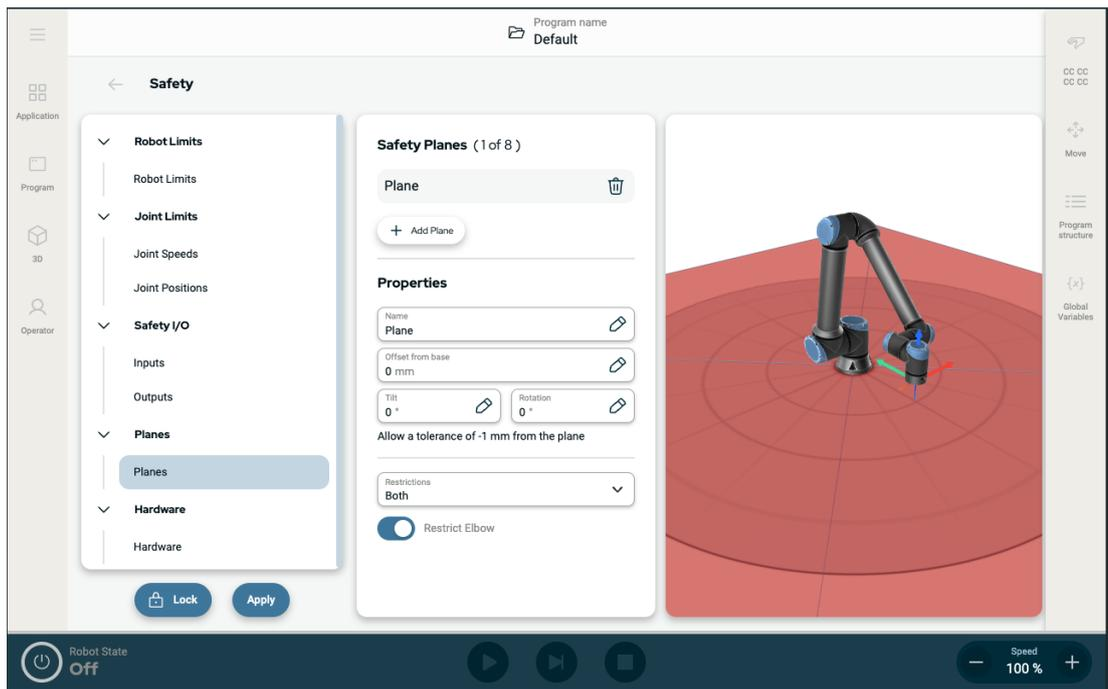
图 1.4: 显示了安全平面的 PolyScope X 屏幕。
