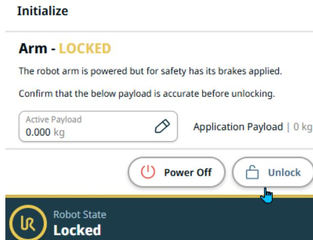
当关节制动器被释放时，机械臂会进行初始化，并伴随声音和轻微的移动。
