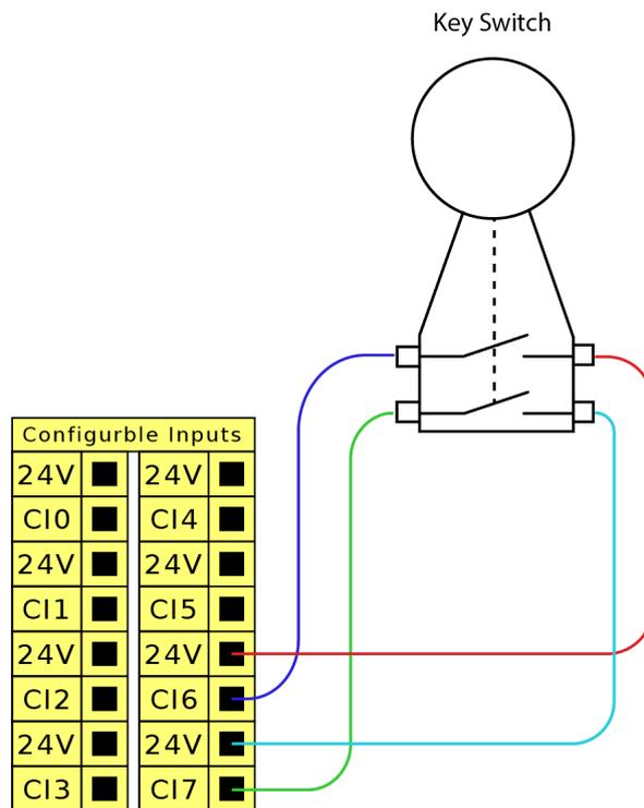
**配置连接的安全输入** 为辅助设备连接配置安全输入时,需要解锁安全 I/O 屏幕。
