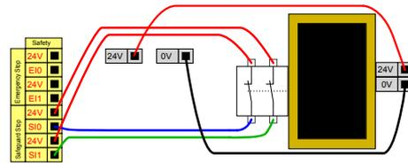
在本例中，安全垫是一种适合自动恢复的安全装置。本例也适用于安全激光扫描仪。
