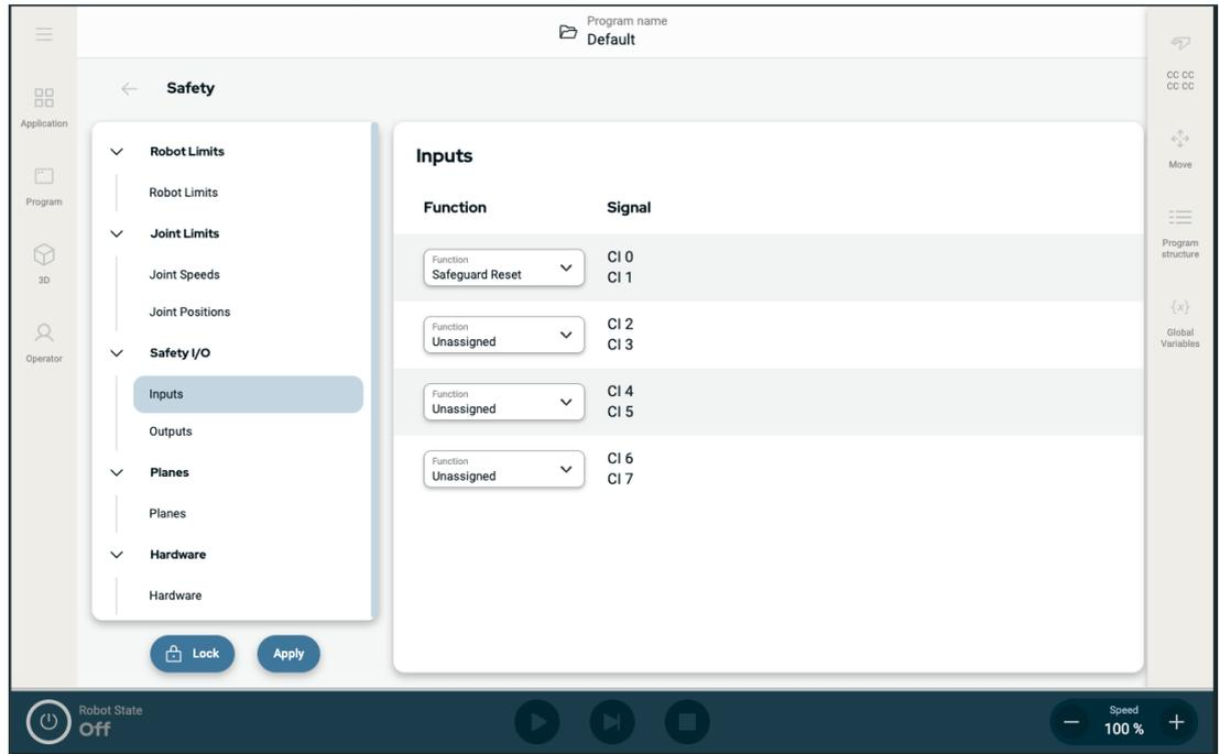
图 1.3: 显示了输入信号的 PolyScope X 屏幕。
